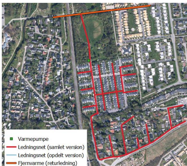
Figur 8: Scenarie baseret på aftapning af varme fra én returledning
