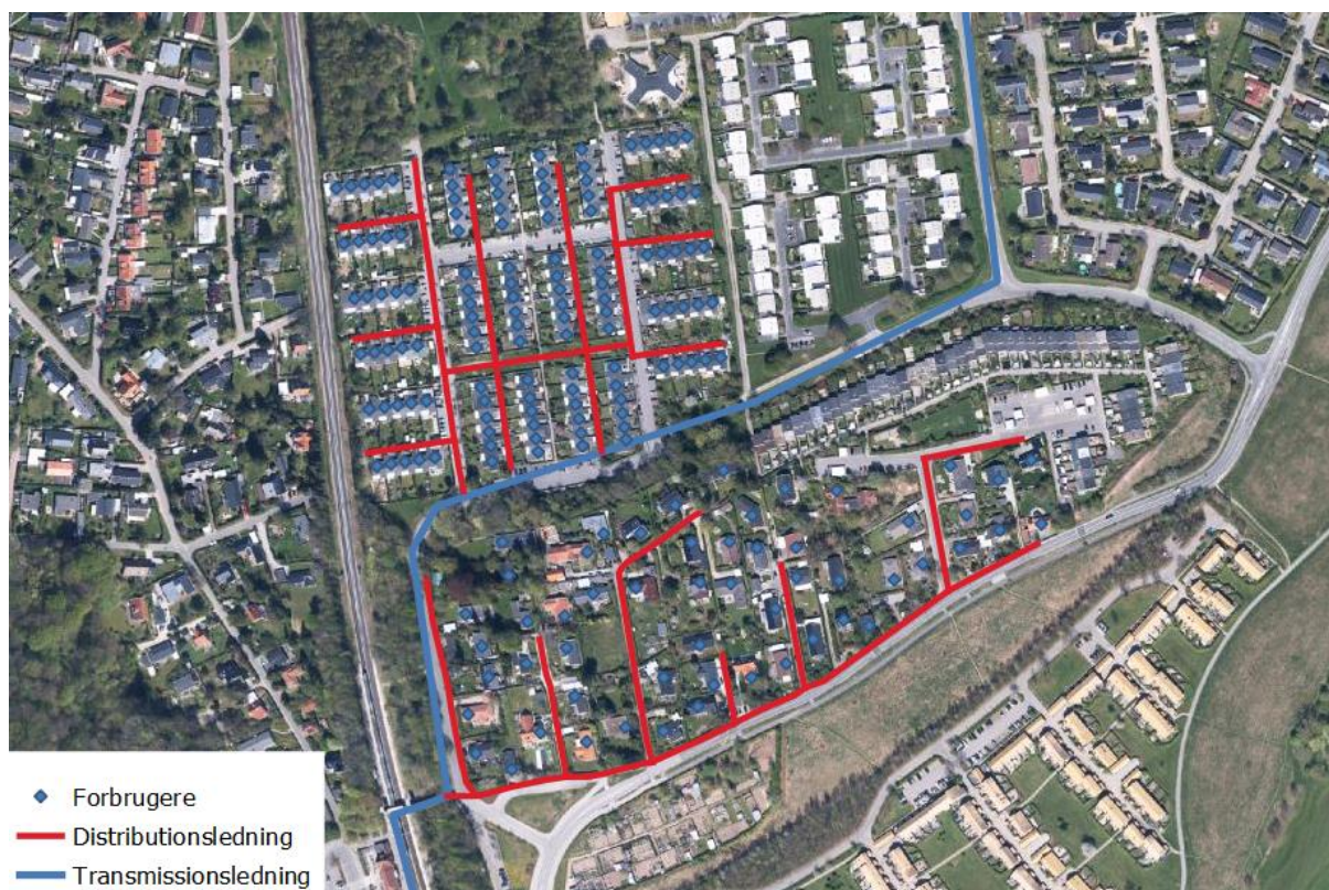
Figur 13: Systemdesign i for Jellerød have og det tilhørende parcelhuskvarter
