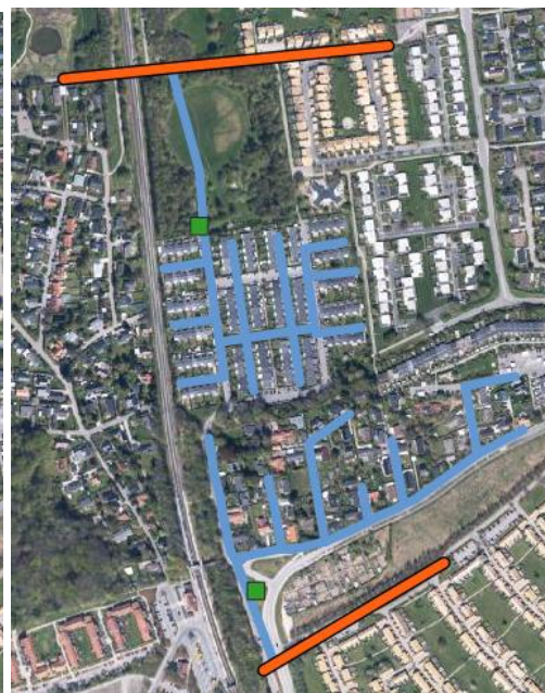
Figur 7: Scenarie baseret på aftapning af varme fra to returledninger
