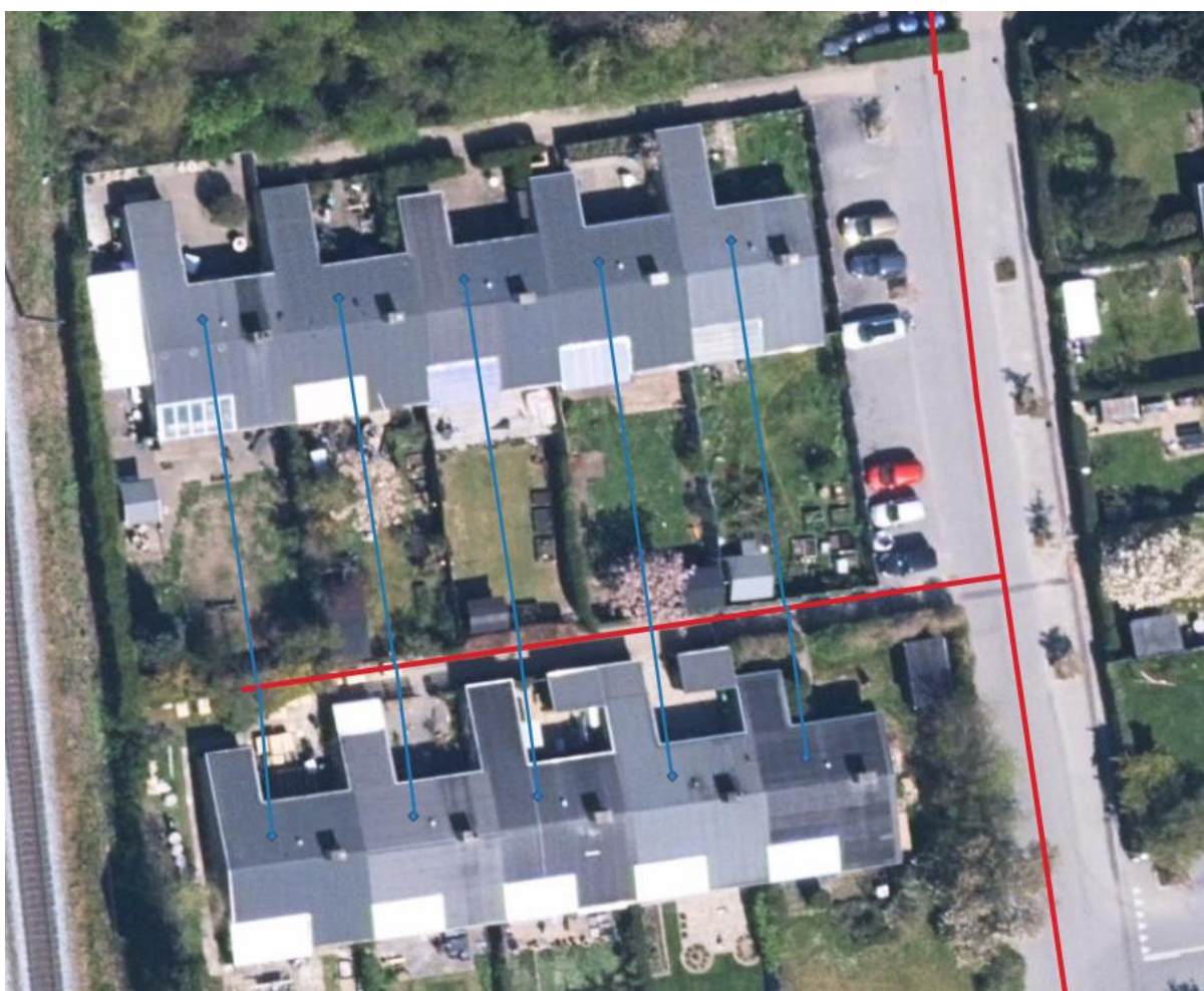
Figur 9: Optegning af stikledning i Jellerød Have
